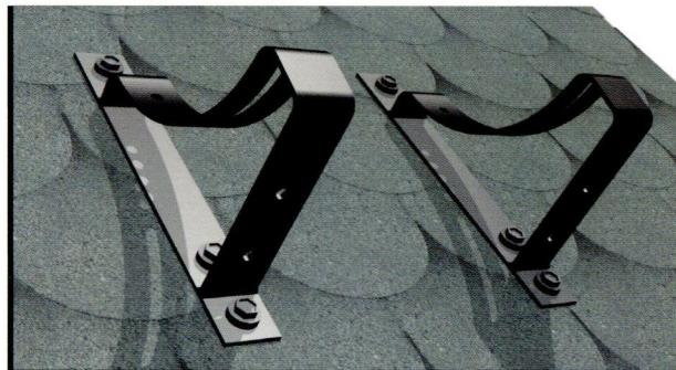
Konzolu (typ U) je treba uložiť na skôr vykonanej plochej strešnej krytine (napr. šindel', lepenka) a priskrutkovať priamo k drevenej konštrukcii strechy.
